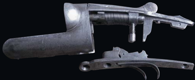
Ударниковый замок Вудварда, патент 1882 года
