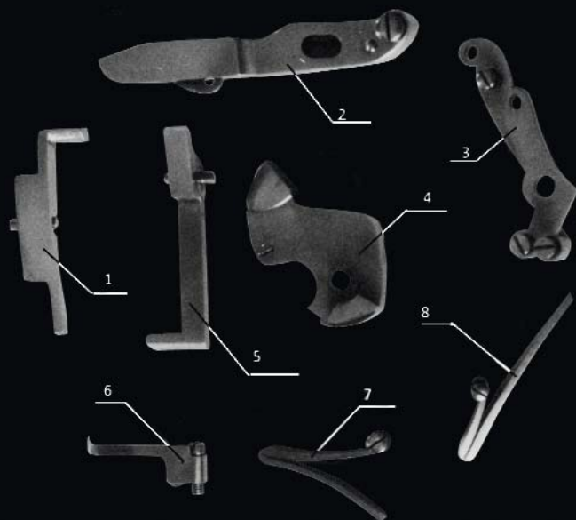
Детали замка: 1 – интерсектор, 2 – нагнетатель (боевая пружина внутри), 3 – личинка, 4 – курок, 5 – шептало, 6 – пружина интерсектора, 7 – пружина нагнетателя, 8 – пружина шептала
