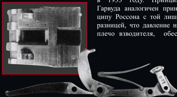
Система Франкотта. Самооткрывающийся замок. Тип «Энсон - Дили»
