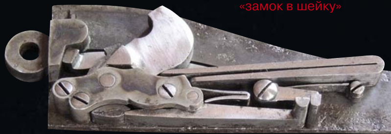
«Обратный» замок или «замок в шейку»
