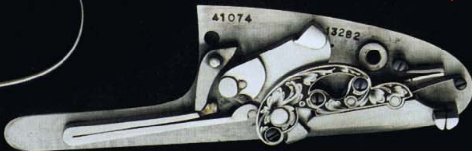
«Обратный» замок или «замок в шейку»
