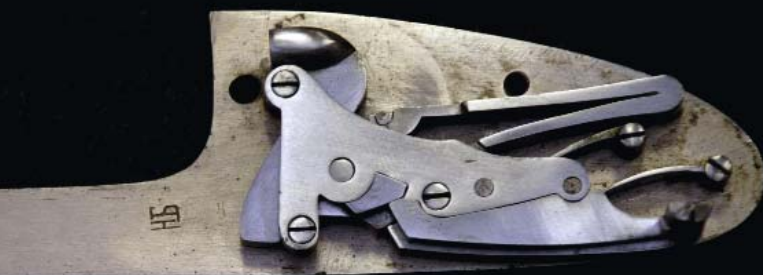
«Ложноподкладной» или замок «льежского» типа. ЦКИБ СОО, ружьё «ТС». У замков этого типа пружина короче, чем у «обратных» замков
